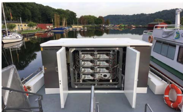
📷 Brændselscellerne har en samlet kapacitet på 35 kW og sørger for at MS innogy kan sejle såvel CO 2 -neutralt som uden at udlede partikler. Foto: SerEnergy
